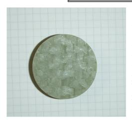
Descrizione: DURAGLAS 250 HQ è una lastra in tessuto di vetro con resina epossidica modificata studiata in maniera specifica per l'isolamento termico delle presse a 250 °C in continuo, su una base di mat di vetro epossidico per alta temperatura. Si caratterizza per le sue eccellenti proprietà meccaniche, bassa igroscopicità e buona stabilità dimensionale. Consigliato per richiesta di alte prestazioni di resistenza meccanica.
